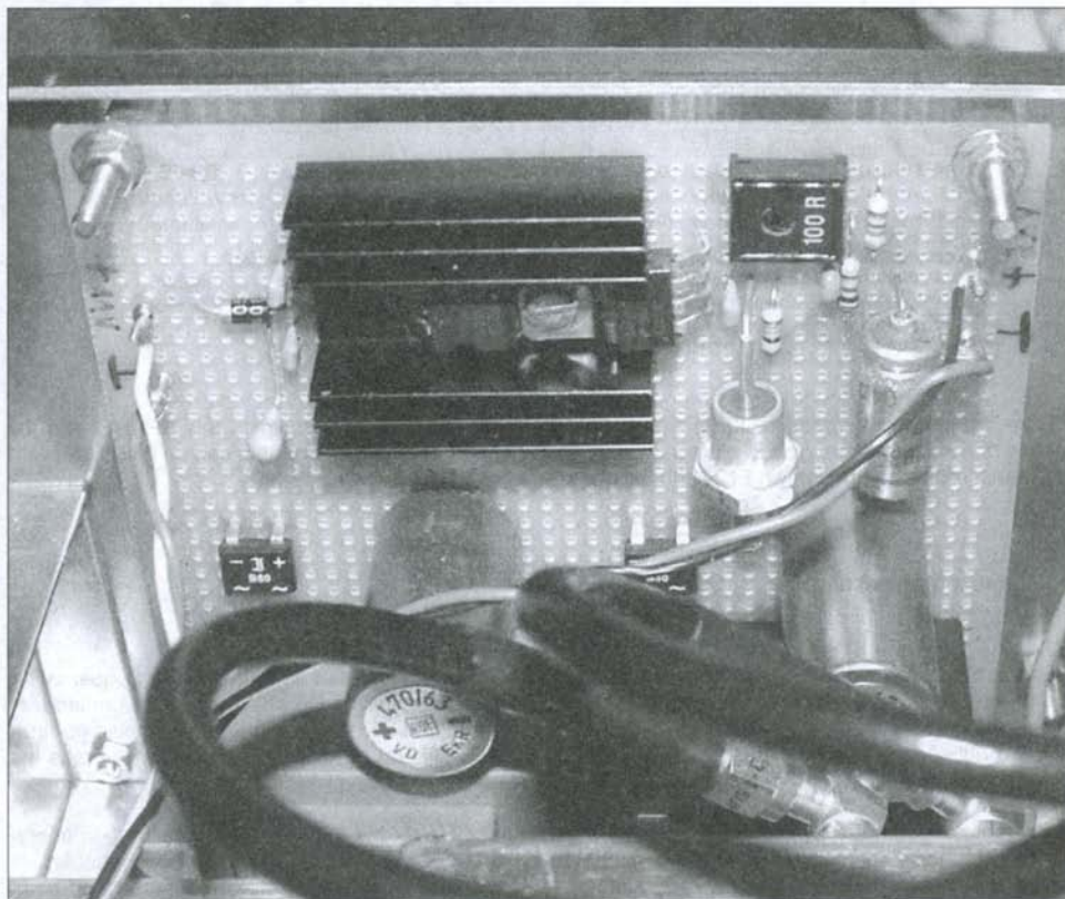
Fig. 10: Realisation of power supply. Abb. 10: Realisierung des Netzteils.
